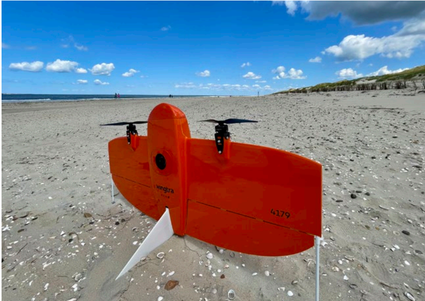
Abb. 2: WingtraOne Gen II Starflügler-Drohne mit VTOL (Fluggeschwindigkeit 16 m/s, Front- und Seitenüberlappung der Bilder 70 %, Flughöhe 100 m, Flugdauer Amrum Odde ca. 20 min, Flächenleistung ca. 100 ha/h) // WingtraOne Gen II fixed-wing drone with VTOL (flight speed 16 m/s, front and side overlap of images 70 %, flight altitude 100 m, flight duration Amrum Odde approx. 20 min, area coverage approx. 100 ha/h). Foto: BioConsult SH.
